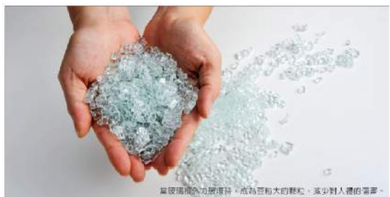
▲玻璃破裂力成碎片，成為百粒大的顆粒，減少對人體的傷害。
